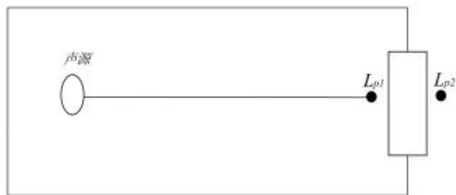
图 4-1 室内声源等效为室外声源图例
